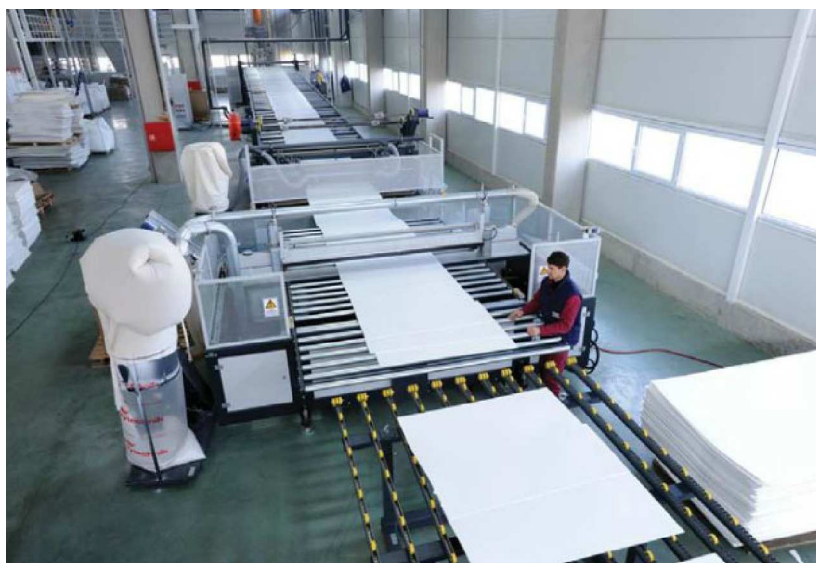
Een van de extrusielijnen die Isca heeft opgezet voor de productie van Plastech kunststofplaten.
